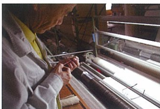
磐田市福田(ふくで)地区のコーデュロイの剪毛工場。この地区の全国シェアは9割以上。剪毛に使うカッターやニードルの調整は、長年の経験や勘がすべて。新製品の開発にも意欲的に取り組む。
